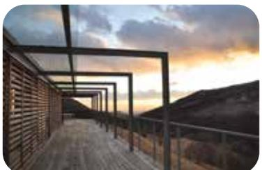
Une pergola bioclimatique peut être aussi bien adossée qu'auto-portée. Fabriquée en aluminium, elle est recouverte de lames orientables motorisées que l'on peut ouvrir ou fermer en fonction des rayons du soleil, pour s'en protéger mais aussi pour laisser entrer la chaleur et la lumière – dans l'espace
